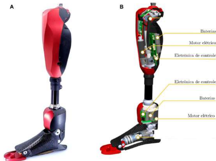
Figura 5 – Imagem da prótese de Utah ao lado de uma renderização 3D expondo as partes principais do sistema e o seu interior, incluindo posicionamento de bateria, motores e a eletrônica embarcada.
