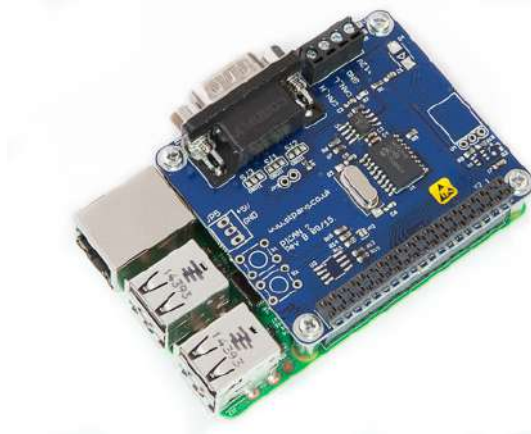
Figura 15 – Imagem ilustrando a placa de extensão para a RPi 4 responsável por permitir uma comunicação por CAN com outro dispositivo.
